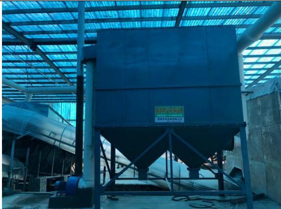
脉冲袋式除尘器+15米高排气筒
